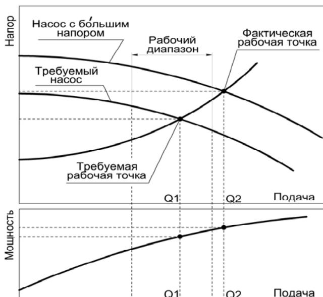
Рис.9. Работа насоса с большим, чем требуется напором
